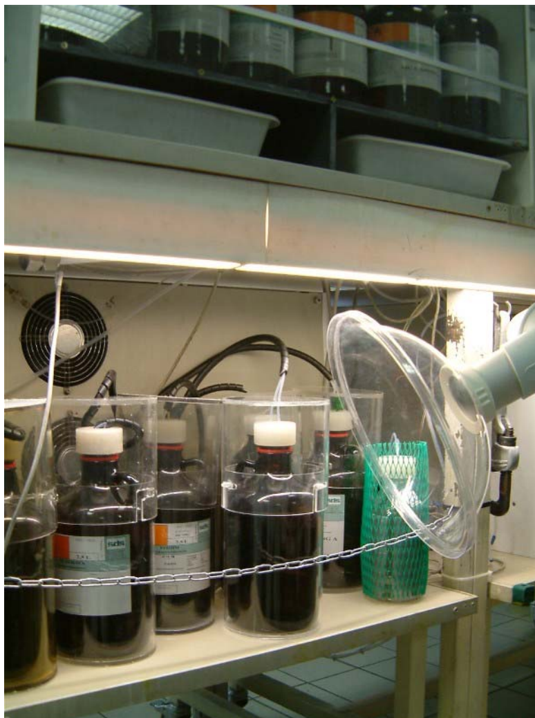
Photo 5 : Dispositif d'aspiration à la source installé auprès du synthétiseur
